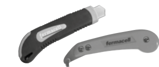
fermacell Ritskniv eller Gipskniv används för att kapa skivorna som därefter knäcks över en kant. Den avbrutna ytan är bra för spackelskarvning men inte lämplig för limskarvning.
