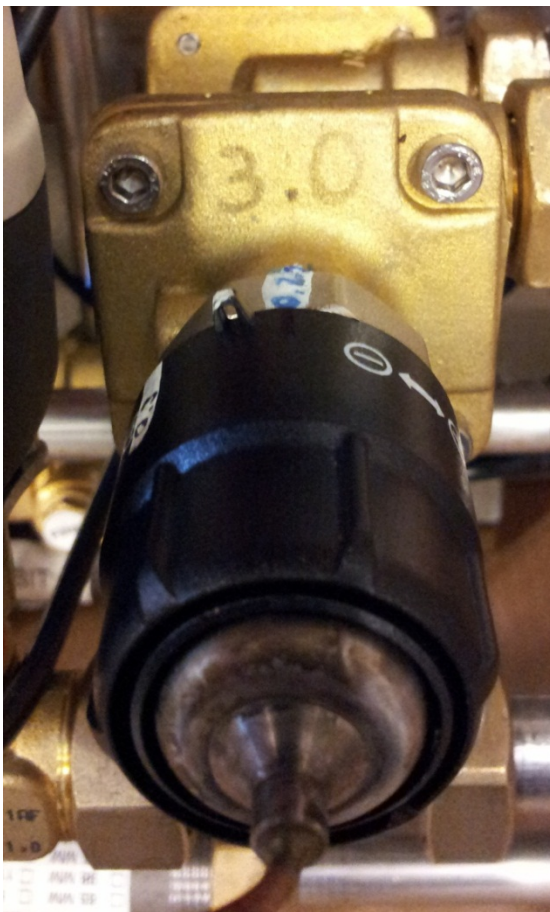
Figur 2. Termostatsens inställning för dynamisk provning (2,75 varv från stängt läge).
