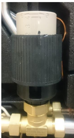
Figur 2. Varmvattenregulatorns inställning för dynamisk provning
