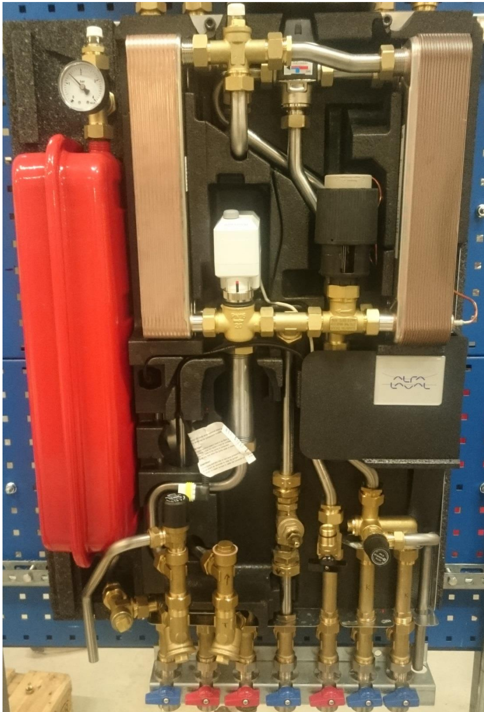
Figur 1. Fjärrvärmecentralen Alfa Laval Mini ECO vid provning.
